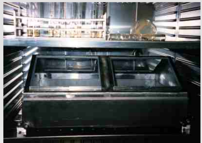
Fermenter zur Gewinnung von Bakteriencelluloseplatten
