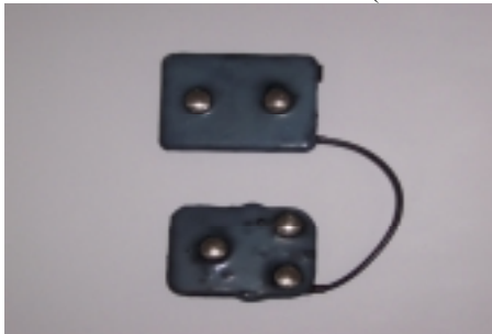
Abbildung 1: Untere Ansicht des Sensors – erkennbare Elektroden.
