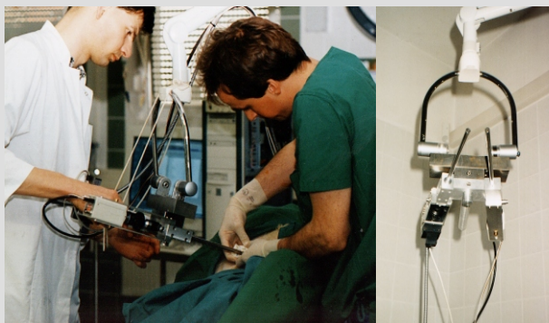
Endoskopische Organvermessung mit einem Prototyp der Meßhardware im Tierversuch
