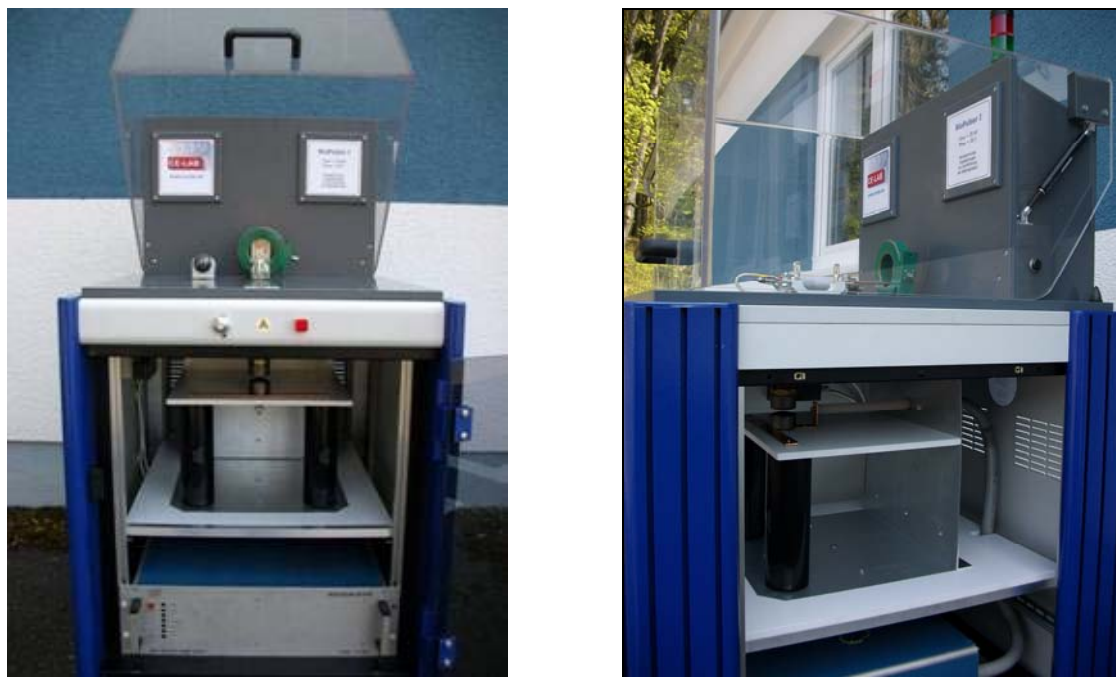
Abb. 5.1: Funktionsmuster Hochspannungs-Impulsgenerator BioPulser I
